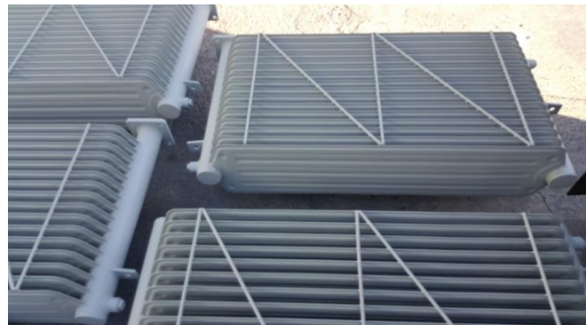
Couche de finition appliquée sur les composantes du transformateur (caissons de contrôle, radiateurs)
