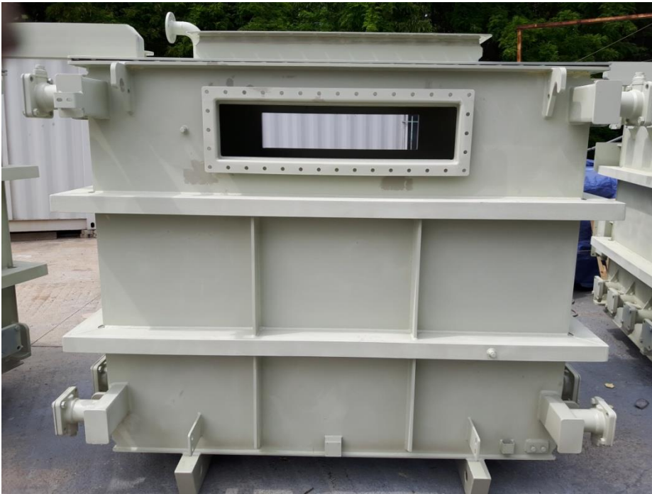
Couche de finition appliquée sur le caisson du transformateur
