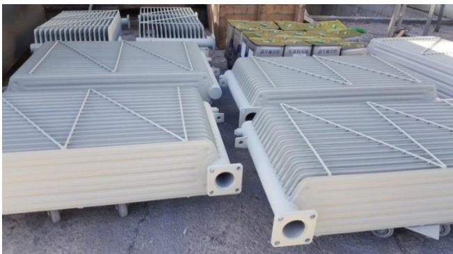
Couche de finition appliquée sur les composantes du transformateur (caissons de contrôle, radiateurs)
