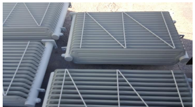
Componenten van de transformators met toplaag.
