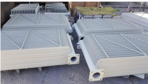
Componenten van de transformators met toplaag.
